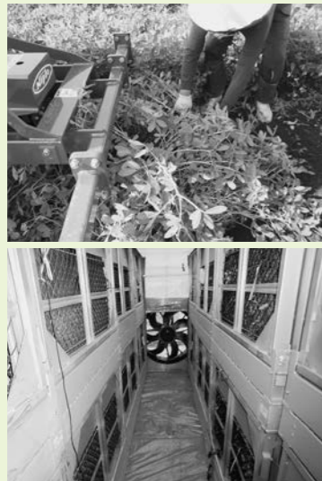
④掘り取りの様子。トラクターに専用の機械を取り付けて行う ⑤コンテナ乾燥機。風を送り水分が9%以下になるまで乾燥させる
