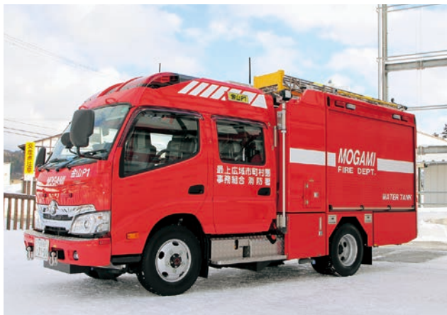
▲車内に水槽が装備しており、すぐに放水ができる消防車
