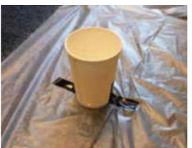
4. 紙コップを加工する 紙コップ下方の両端2か所に麻ひもが通る大きさの穴をあける。その紙コップをビニールシートの上に固定する。
