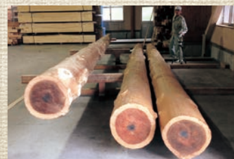
④伐り出された金山杉は、柱・梁用などに製材された。
